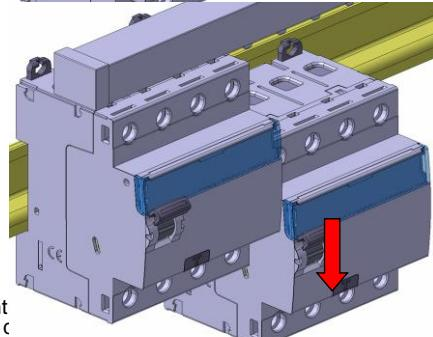
Tirer l'appareil vers l'avant afin de le dégager du rail
